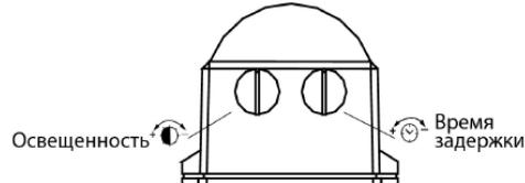
6.1 Поверните регулятор TIME (ВРЕМЯ ЗАДЕРЖКИ) до минимума (–) положение против часовой стрелки. Поверните регулятор LUX (ОСВЕЩЕННОСТЬ) в положение Солнца по часовой стрелке (+).
