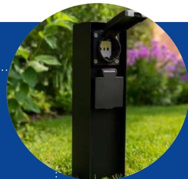
Розетка уличная садовая оснащена двумя евророзетками с крышками и контактами заземления, суммарный ток составляет 16А. Муфта IP68 для соединения проводов идет в комплекте. Длина кабеля TM200: 85 мм.
