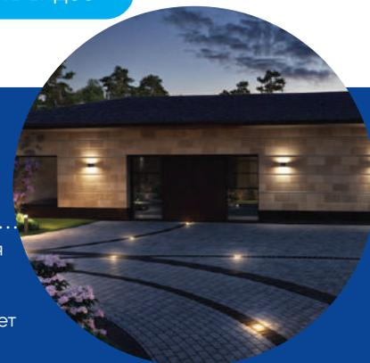
Светильник устанавливается в грунт вдоль дорожек, либо непосредственно в сами дорожки, а так-же может подсвечивать ландшафтные элементы и фасады.
