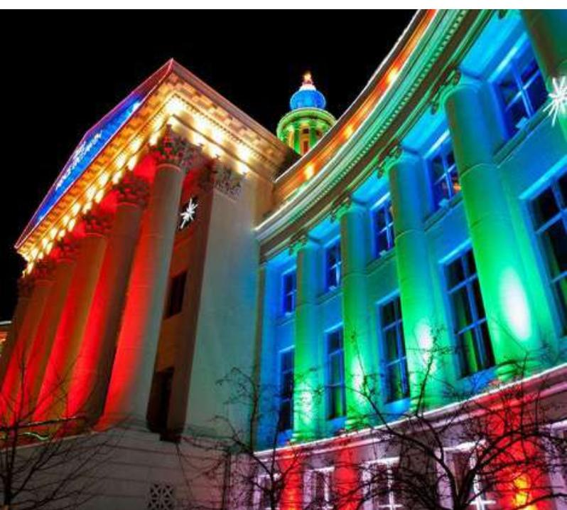
Светодиодные прожекторы для архитектурной и фасадной подсветки активно используются в художественной подсветке фасадов зданий, колонн, ниш. За счет направленного света в оптике линз с узким углом свечения можно подсвечивать определенные архитектурные элементы. Крепление позволяет регулировать направление свечения. За счет направленного света с углом свечения 20° можно подсвечивать определенные архитектурные элементы.
