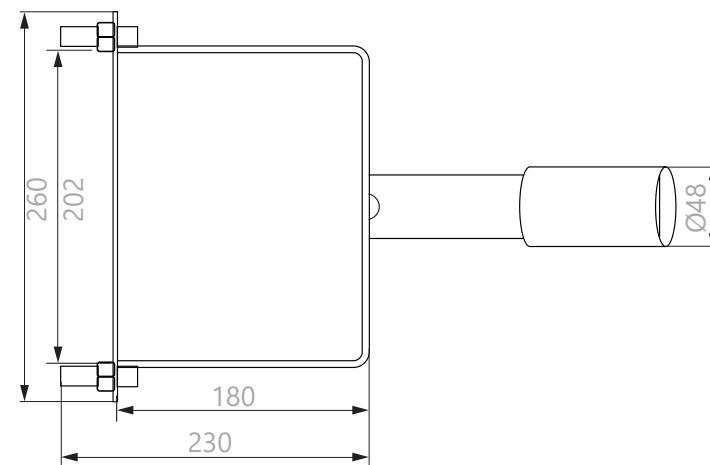
Кронштейн с фиксированным углом ДС-3 ТМ Feron предназначен для крепления консольных светильников на опору или столб.
