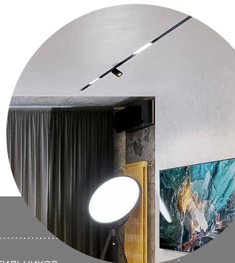
Особенностью трековых светильников AL130, AL131, AL132 является повышенное качество драйвера светодиодов, который включает в себя фильтр подавления радио и сетевых помех, устойчив к воздействию скачков напряжения большой мощности. Эффективное и качественное освещение благодаря Feron становится доступнее! Алюминиевый корпус с порошковой окраской, высокое качество комплектующих и сборки, а главное – сбалансированный ассортимент.
