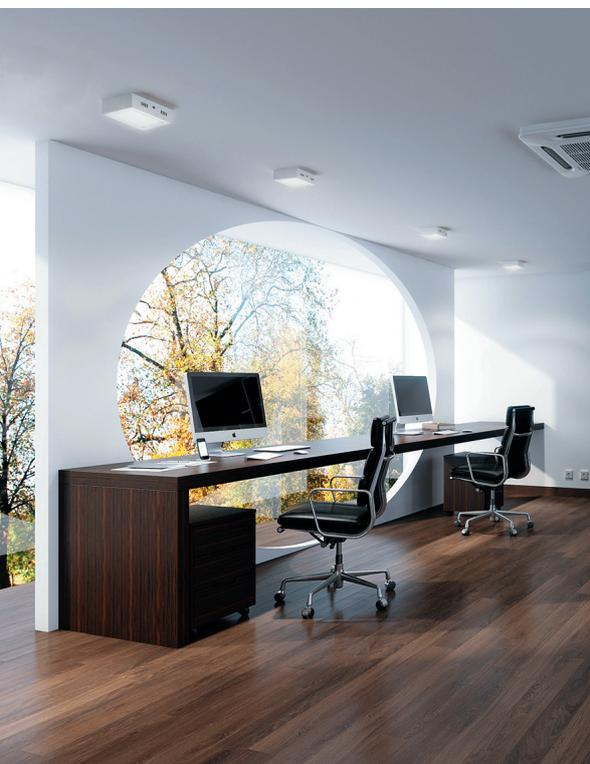
Накладные светодиодные светильники Feron AL504 и AL505 предназначены для освещения помещений общественного пользования и коммерческой недвижимости. Светильники легко монтируются и не требуют дополнительных затрат на дальнейшее обслуживание. Алюминиевый корпус и рассеиватель из акрилового полимера обеспечивают повышенную прочность светильника, что очень важно для общественных помещений.
